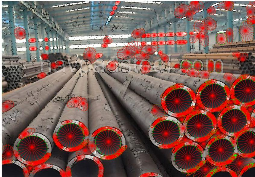
Abbildung 4: Ein Debugging-Bild des Spider-Algorithmus. Die schwarzen Punkte sind Marker, wo der Spider-Algorithmus Kanten detektiert hat. Grüne Ellipsen stehen für einen hohen Score, rote für einen niedrigen.
