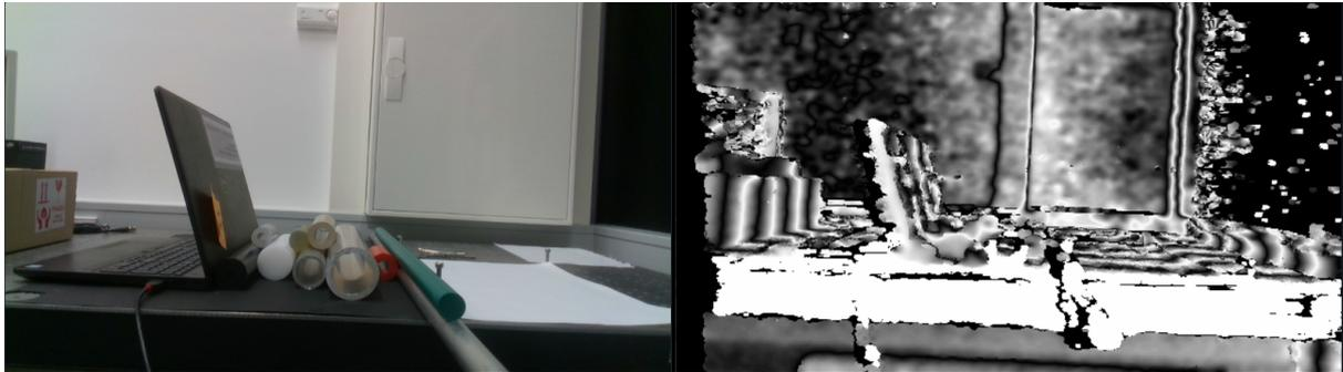
Abbildung 18: Die Streifenvisualisierung ist gut zur Fehlerabschätzung: auf Ebenen sollten die Streifen möglichst gerade sein.
