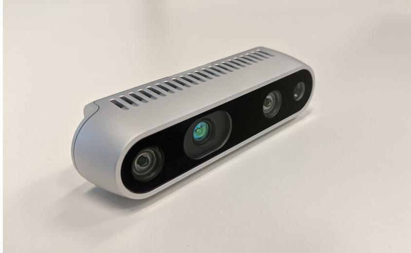
Abbildung 15: Bild des D435; Von links nach rechts: rechte Stereo-IR-Kamerahälfte, IR-Projektor, linke IR-Stereohälfte, Farbkamera
