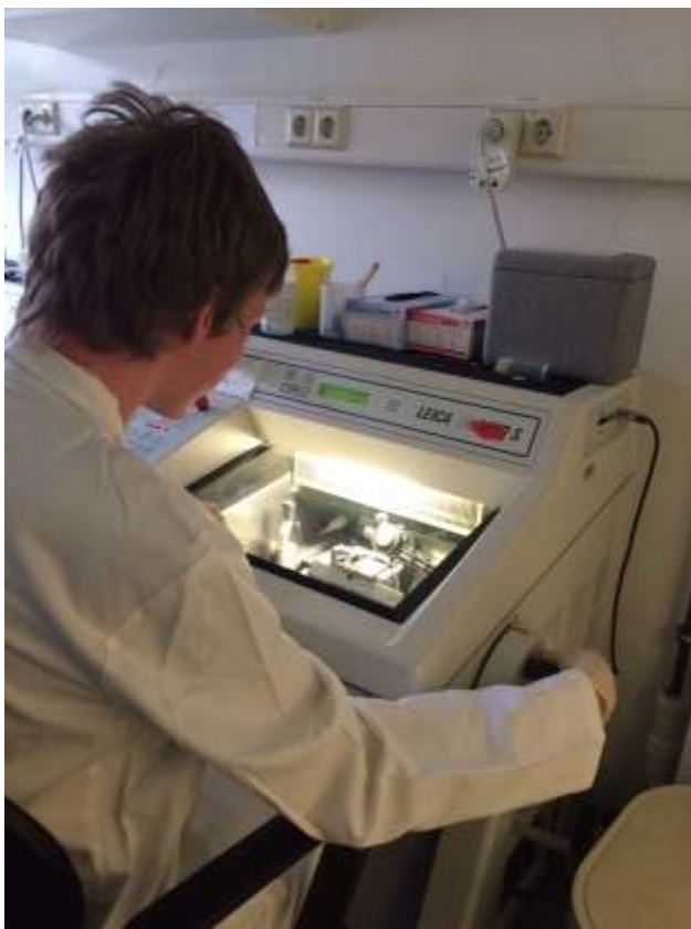
Schneiden der Proben auf Mikrometer genau
